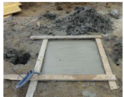
FOT. 2. Czujnik do pomiaru ciśnienia gruntu pod płytą fundamentową
