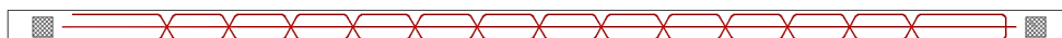
Rysunek 4. Trasy włókien pomiarowych (S1/1, S1/2, S1/3) w widoku z dołu pasa dolnego dźwigara
