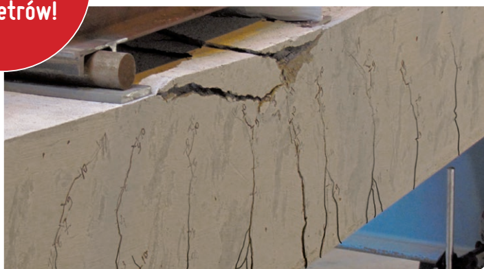
Pomiar ekstremalnie szerokich rys czujnikiem EpsilonSensor
